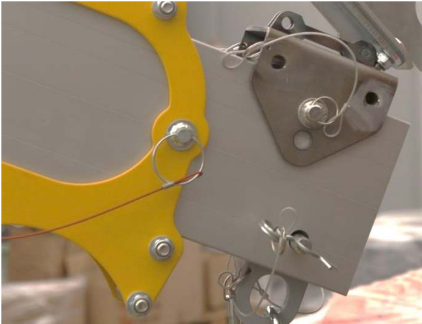
Rysunek 13 - Uniwersalny uchwyt do wciągarek PAD100-301-000 zamocowany na końcu wysięgnika.
